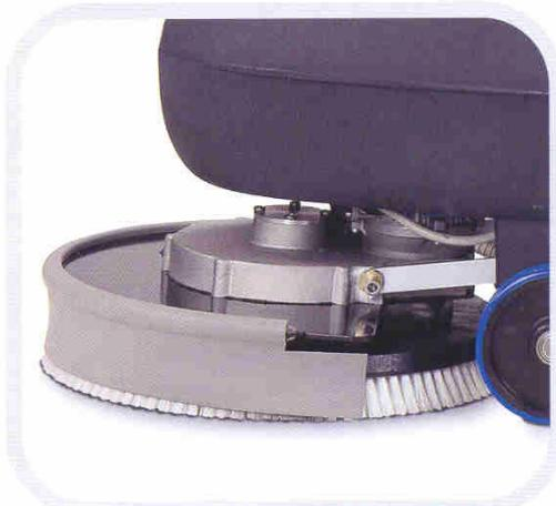
Le nouveau suceur en aluminium moulé sous pression, étudié pour optimiser l'aspiration et simplifier le démontage des bavettes d'aspiration, est facilement réglable et assure un résultat de séchage parfait sur n'importe quelle surface. Les bavettes d'aspiration en caoutchouc sont réversibles et peuvent travailler sur les quatre cotés.
